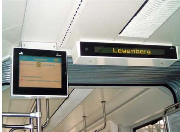
Fahrgastfernsehen und Innenanzeige am ersten Gelenk in einer Straßenbahn vom Typ SN 2001.
