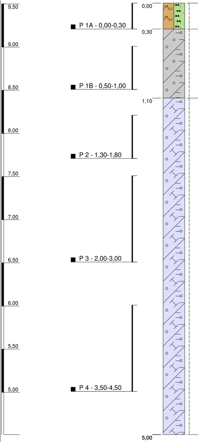
0,30, Schluff, feinsandig bis schwach feinsandig, humos bis schwach humos, vereinzelt Kies, vereinzelt Wurzeln (Reste), Mutterboden, dunkelbraun, steif, feucht, leicht zu bohren, kalkfrei
