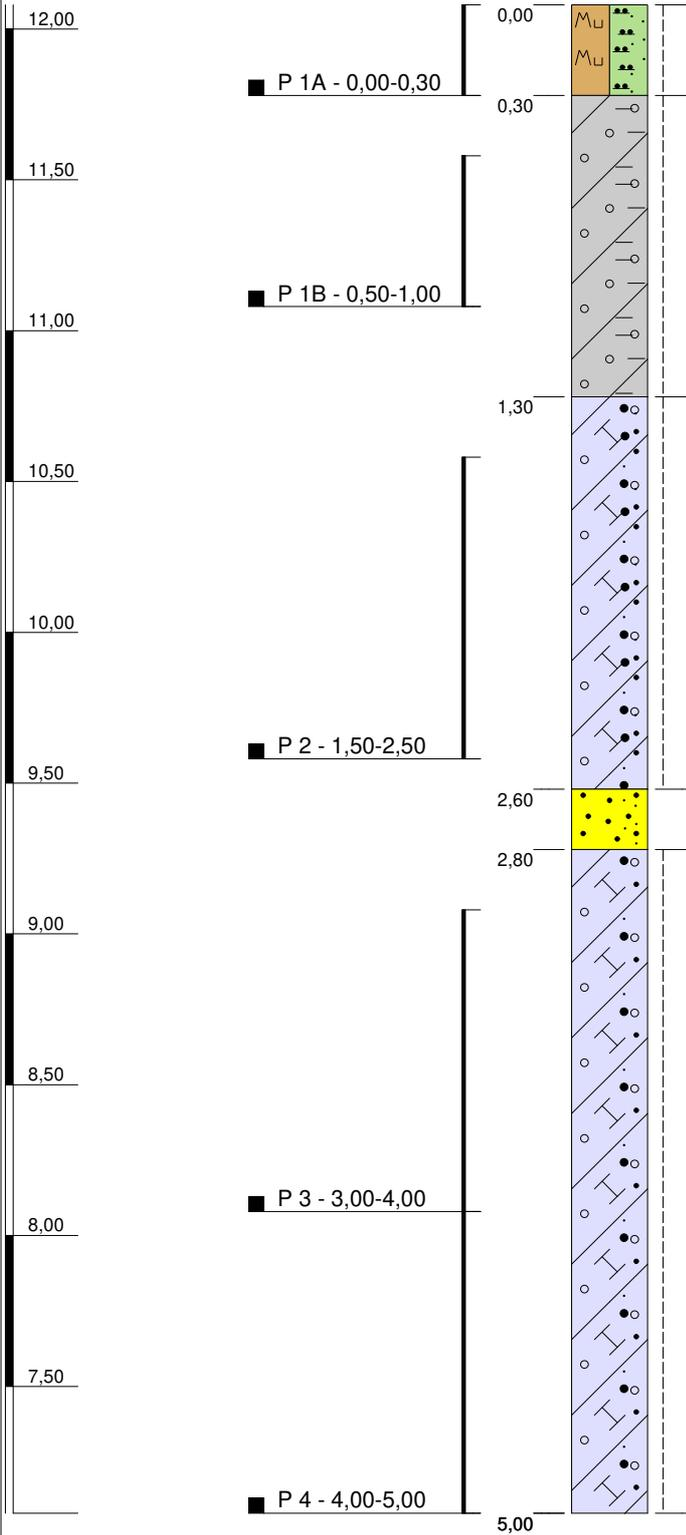
0,30, Schluff, stark feinsandig bis feinsandig, humos bis schwach humos, vereinzelt Kies, vereinzelt Wurzeln (Reste), Mutterboden, dunkelbraun, steif, feucht, leicht zu bohren, kalkfrei
